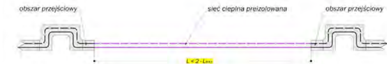
Rysunek 85: Sieć cieplna do przykładu nr 3 po przebudowie
