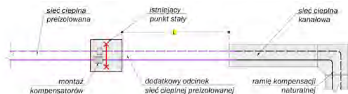
Rysunek 100: Zastosowanie dodatkowego odcinka sieci cieplnej preizolowanej
