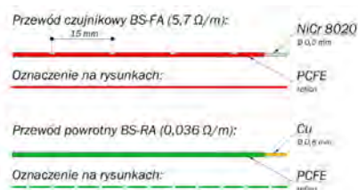
Rysunek 3: Przewody systemu rezystancyjnego
