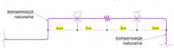
Rysunek 72: Zastosowanie pojedynczego kompensatora mieszkowego – preizolowanego
