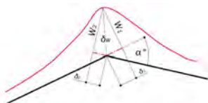
Rysunek 41: Przesunięcie wierzchołka rurociągu i wydłużenia przeliczeniowe
