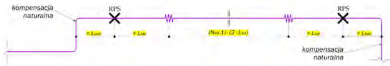
Rysunek 73: Stosowanie rzeczywistych punktów stałych między skrajnymi kompensatorami a kolanami kompensacyjnymi
