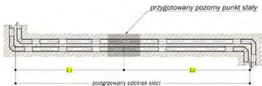
Rysunek 69: Przygotowanie rurociągów do podgrzewu wstępnego – pozorny punkt stały
