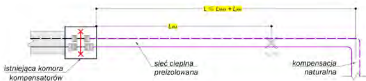
Rysunek 91: Sieć cieplna do przykładu nr 6 po przebudowie bez zastosowania rzeczywistego punktu stałego
