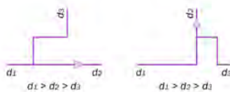
Rysunek 46: Lokalizacja zwężki w zależności od przebiegu średnic rur przewodowych
