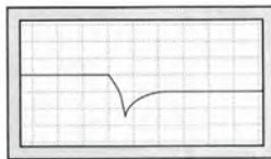
Rysunek 142: Obraz zwarcia na wyświetlaczu reflektometru
