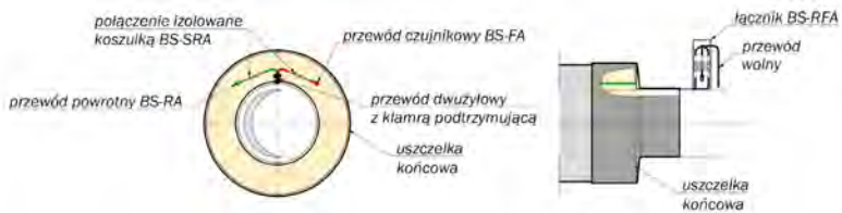
Rysunek 134: Wyprowadzenie przewodów do pomiarów
