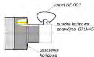
Rysunek 150: Montaż puszki końcowej podwójnej 67LV45 z kablem KE-001
