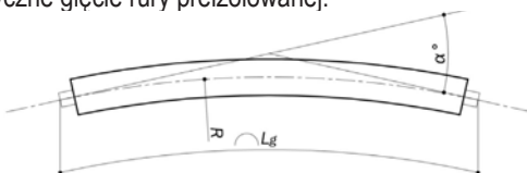
Rysunek 45: Parametry charakterystyczne rury giętej elastycznie
